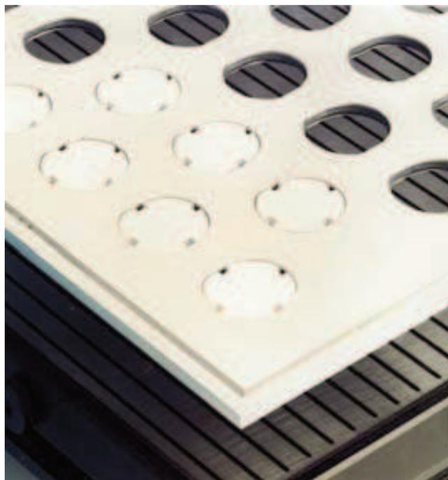
**Vakuum-Schlitzplatte mit werkstückspezifischer Adaptermaske**
