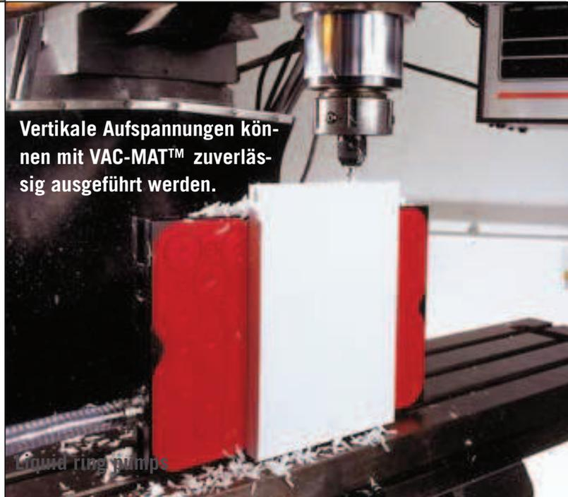
Vertikale Aufspannungen können mit VAC-MAT™ zuverlässig ausgeführt werden.
