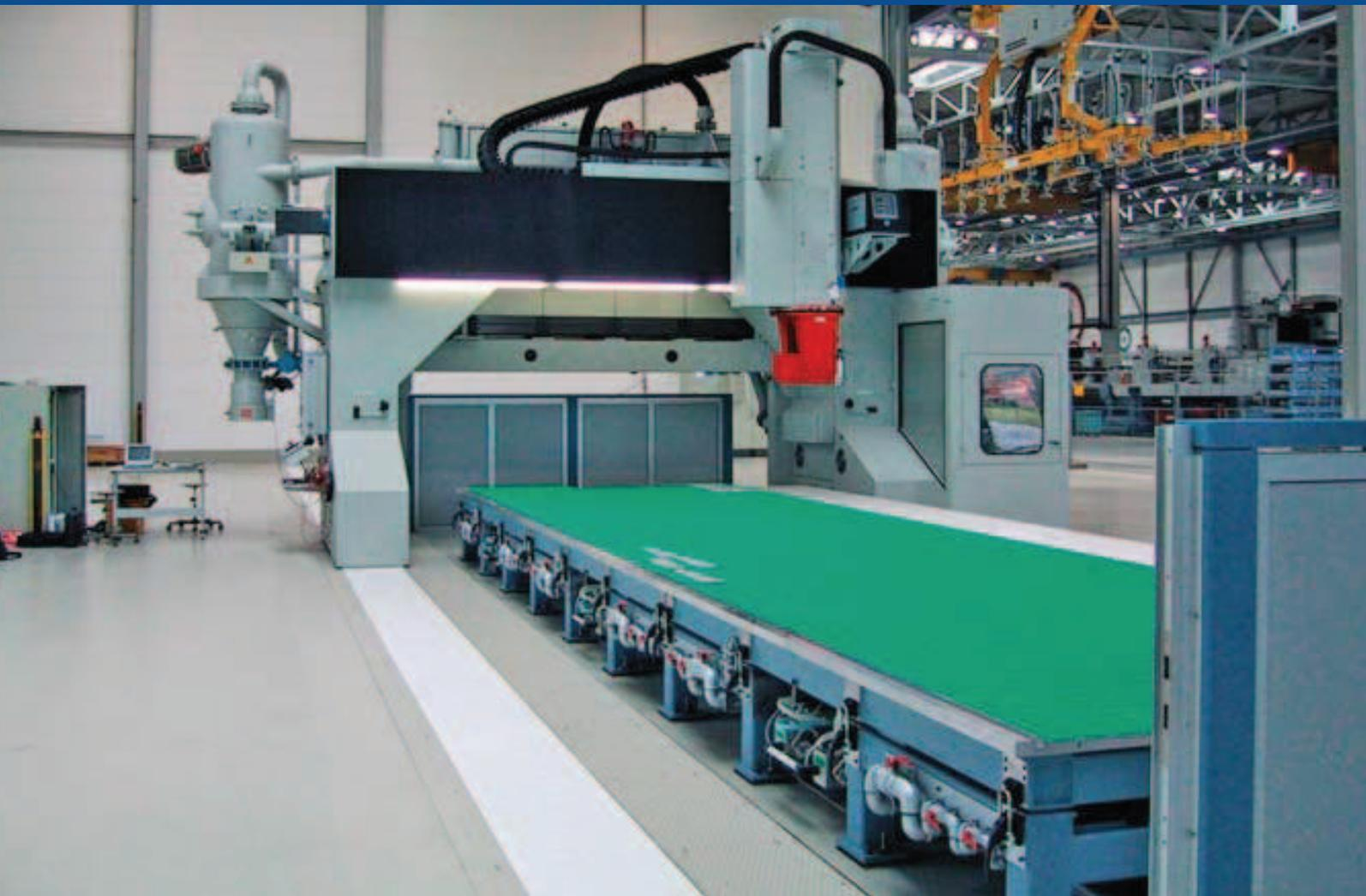
Maschinentisch 3,3x11m, ausgerüstet mit VAC-MAT™ Vakuumsystem. Hier erfolgt auf 468 Matten Taschenfräsen zur Gewichtsreduzierung von Flugzeug-Hautfeldern.
