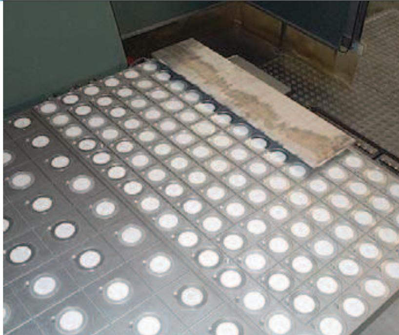
◀ FLIP-POD™ Spannsystem zum Spannen eines großen Aluminiumteiles mit Durchbrüchen
