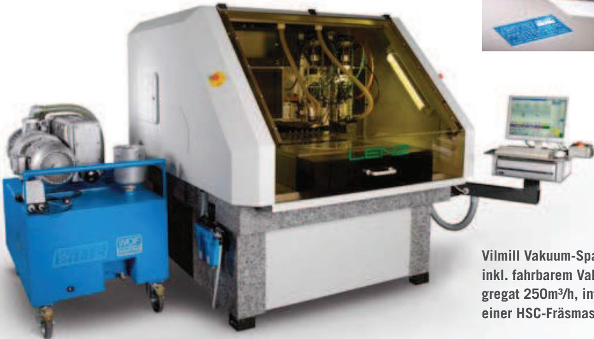
Vilmill Vakuüm-Spannsystem inkl. fahrbarem Vakuüm-Aggregat 250m<sup>3</sup>/h, integriert auf einer HSC-Fräsmaschine.
