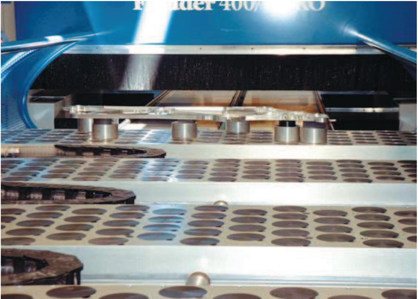
**FLIP-POD™-Spannvorrichtung für eine CNC Entgratmaschine, zum Entgraten von Flugzeug-Bauteilen.**
