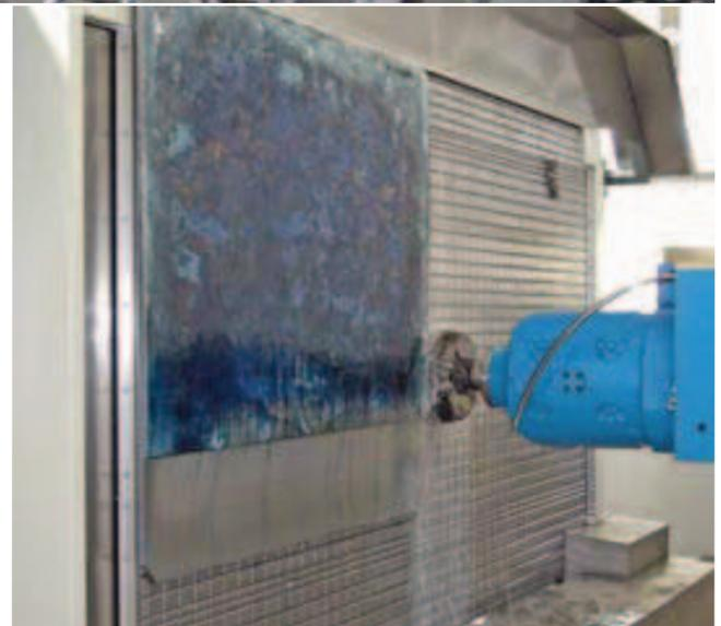
**Vakuum-Spannvorrichtung mit autom. Werkstück-Anschlagsystem, montiert auf einem Kipptisch. Alle Funktionen des Vakuumspann- und Anschlagsystems, sowie die Bereitstellung des Betriebsvakuum über eine Zentralanlage, sind vollautomatisch softwaregesteuert.**
