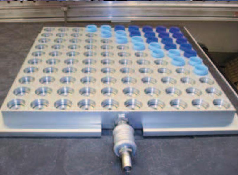
Vakuum- Spannplatte zum Spannen von Getränkeverschlüssen beim Messvorgang auf Koordinaten-Messmaschinen.
