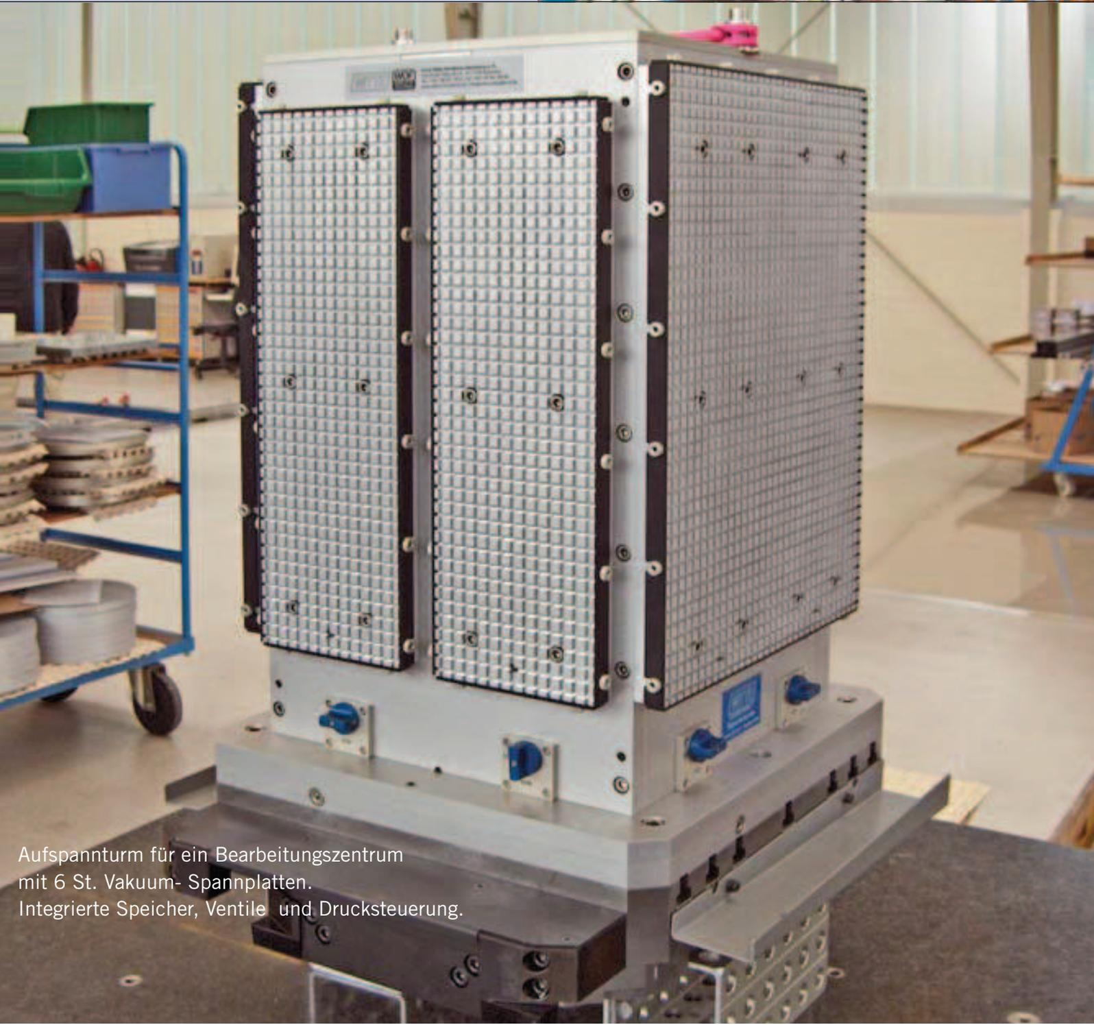
Aufspannturm für ein Bearbeitungszentrum mit 6 St. Vakuum- Spannplatten.
