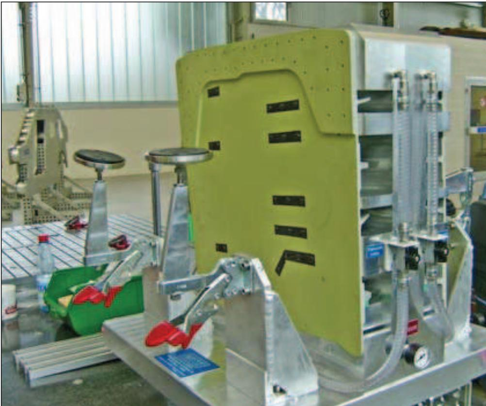
Doppelseitiger Spannkubus für die Kontur- und Bohrbearbeitung von linken/rechten Aluminium Beschlügen.
