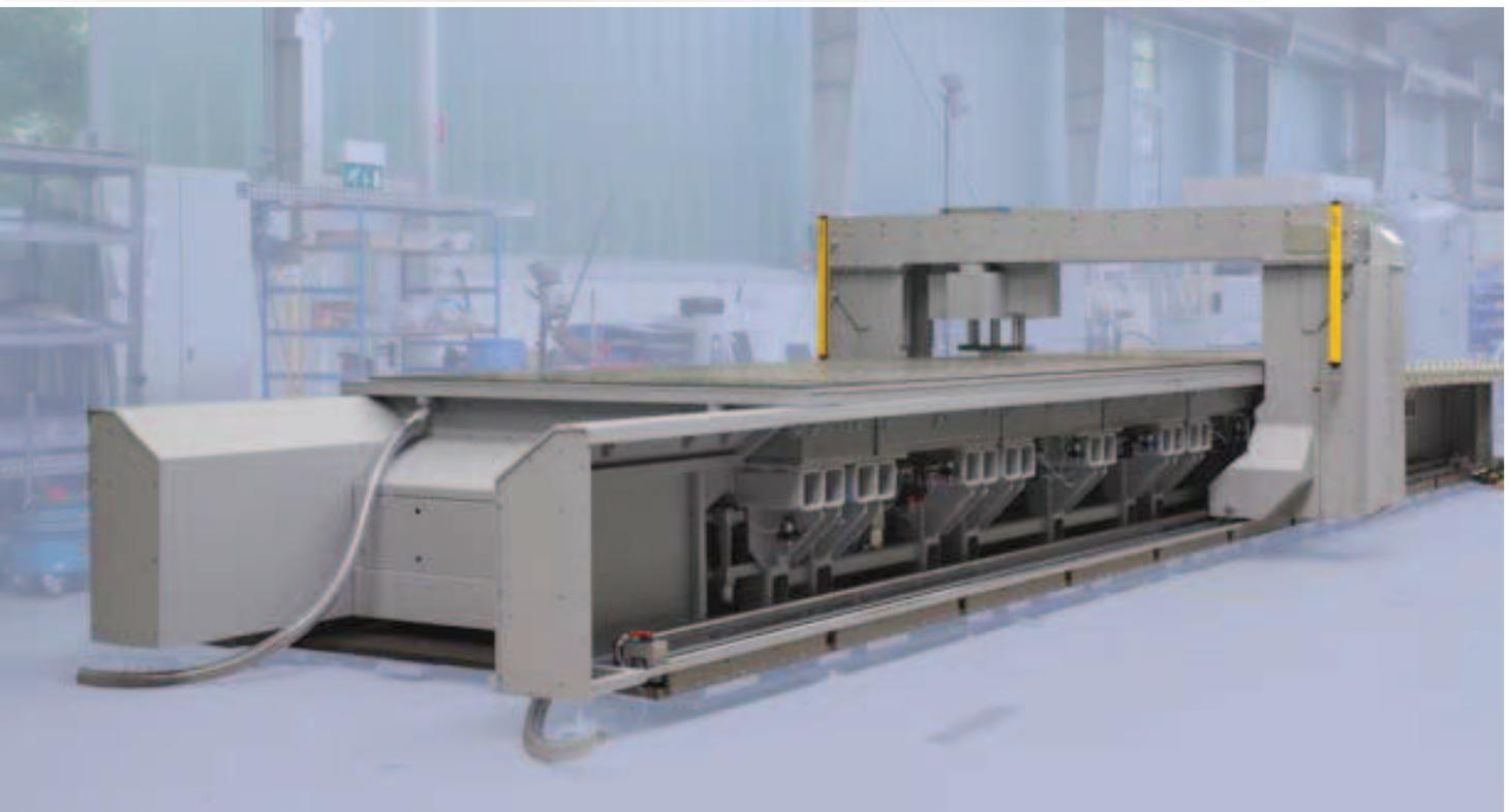
Vakuüm Spannvorrichtung mit eigenem Portal und Hydraulik-Stempel (2to.) zum punktuellen Andrücken von großformatigen Aluminium Werkstücken.
