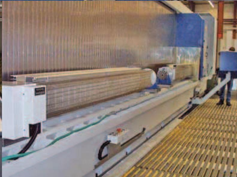
Horizontale Wendespanner 300x3500 mm mit Vakuum - Spannplatten auf 4 Seiten zur Aufnahme von Alu-Profilen.
