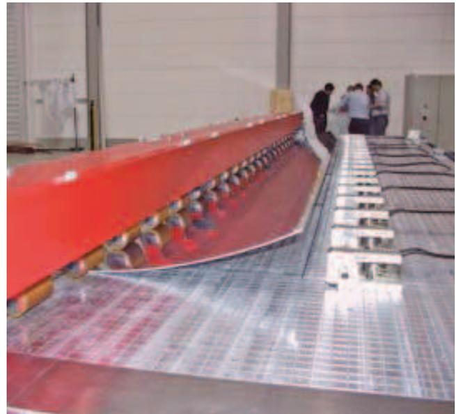
Spannsystem zum Vakuumspannen von zylindrisch vorgewalzten Aluminiumblechen bis zu einer Größe von 4 x 11 mtr. Ein automatisch verfahrenender Druckbalken drückt gewalzte Alu-Hautfelder auf eine Vakuum-Spannplatte, die sensorgesteuert die jeweilig benötigten Vakuumbereiche aktiviert. Hydraulische und pneumatische Spannelemente unterstützen die Werkstückfixierung.
