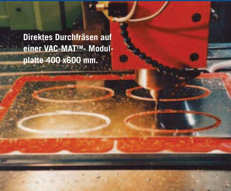
Direktes Durchfräsen auf einer VAC-MAT™- Modulplatte 400 x600 mm.
