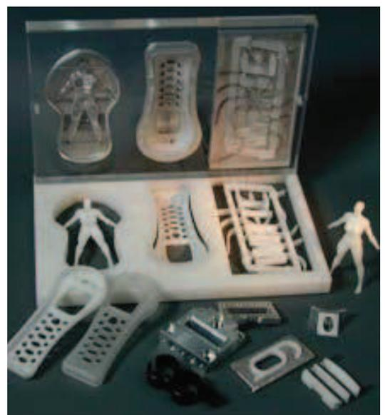
Das Witte Weiguss Verfahren eignet sich besonders für kompliziert/sphärisch geformte Werkstücke
