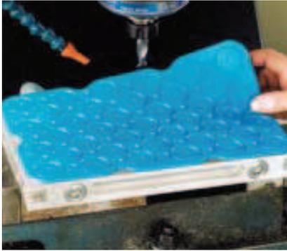
Die Führungsnoppen auf der Unterseite gewährleisten die schnelle und genaue Positionierung der VAC-MAT™ auf der Vakuumpatte
