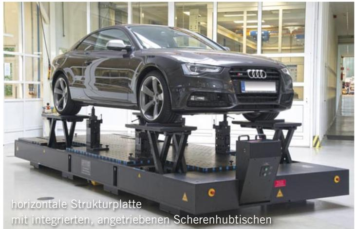
horizontale Strukturplatte mit integrierten, angetriebenen Scherenhubtischen
