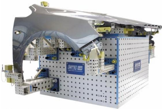
Fixbase Box für Aufnahme Einzelteile Vorderwagen
