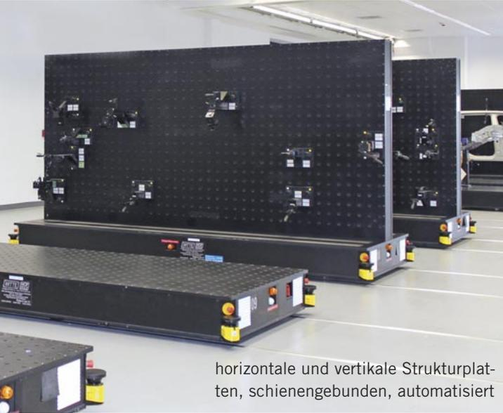
horizontale und vertikale Strukturplatten, schienengebunden, automatisiert
