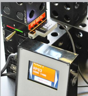
Die LEaD-Positionierhilfe wird sowohl als werkseitig in Rasterplatten von Witte integriertes System angeboten als auch – separat erhältlich – für den Vorrichtungsaufbau mit dem modularen Spannsystem ALUFIX.
