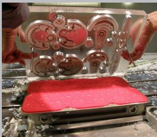
Gerade bei filigranen, komplizierten Bauteilen, die einen Toleranzwert von unter einem Hundertstel haben, gilt als oberstes Ziel die Maßhaltigkeit. Beim Arbeiten mit dem Weiguss-Verfahren von Witte werden solch enge Frästoleranzen problemlos eingehalten.
