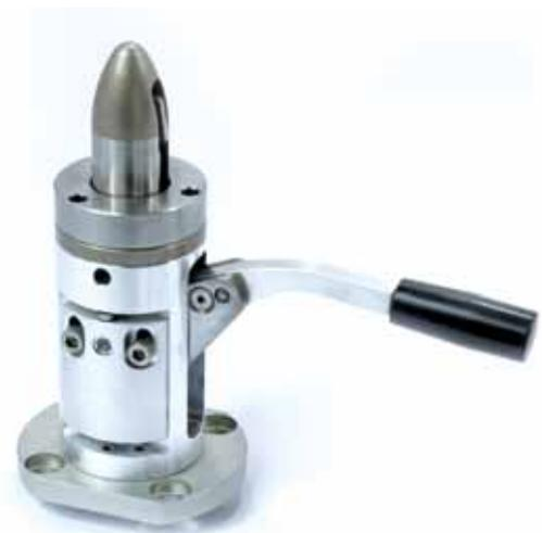
Innenliegender Exzenterhebel. Aufsatzkörper und Auflageringe sind 100% kompatibel (Außenabmaße identisch mit den bisherigen Hakenspannern). Seitliche Betätigung über Innensechskant möglich.
