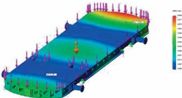
Alle Strukturplatten werden mittels FEM-Analyse auf Belastbarkeit und Steifigkeit geprüft und optimiert
