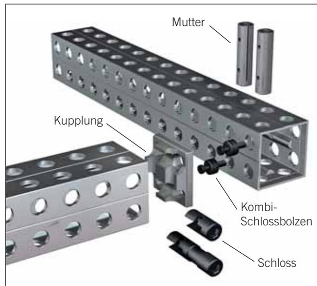
**Einfache Kupplungen mit Schraub- / Schnellverbindung (Kombi-Schlossbolzen)** werden in Quadern Light stirnseitig zur genauen Positionierung von Anbauteilen verwendet. Im Bild in Verbindung mit Schraub- und Schnellverbindern
