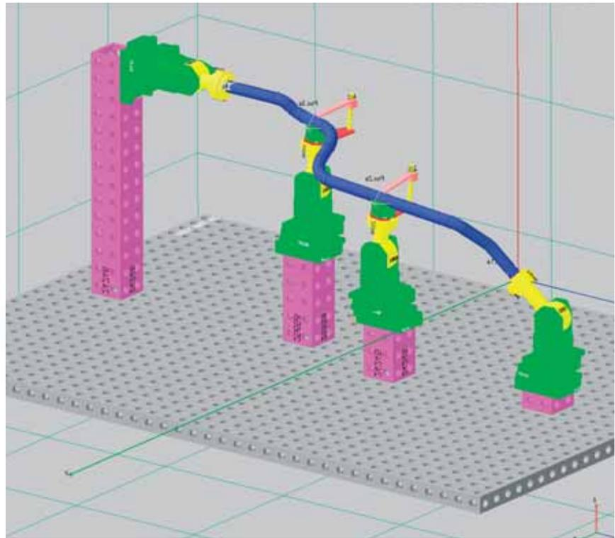
Messaufnahme für einen Schlauch. Mit Hilfe der Software Alufix-Experte (Seite 186) lassen sich die erforderlichen Positionen und Einstellwinkel leicht berechnen. Messaufnahmen dieser Art sind so in kürzester Zeit realisierbar.
