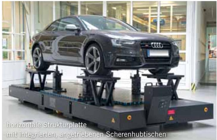
horizontale Strukturplatte mit integrierten, angetriebenen Scherenhubtischen
