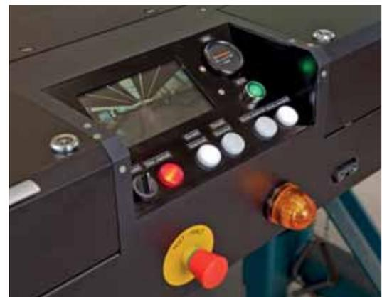
Bedienpult mit Fahrkamera-Monitor
