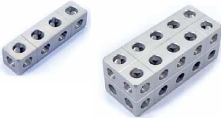
Alufix Vollquader dienen bei der Erstellung von kleinen bis mittleren Vorrichtungen als Bindeglied zwischen Basis und Werkstückaufnahme. Sie lassen sich an allen sechs Seiten mittels Schnell- und Schraubverbindern verbinden und sind somit sehr flexibel einsetzbar. Die nachfolgend aufgeführten Größen sind unsere Standardgrößen, andere Abmessungen sind auf Anfrage lieferbar.
