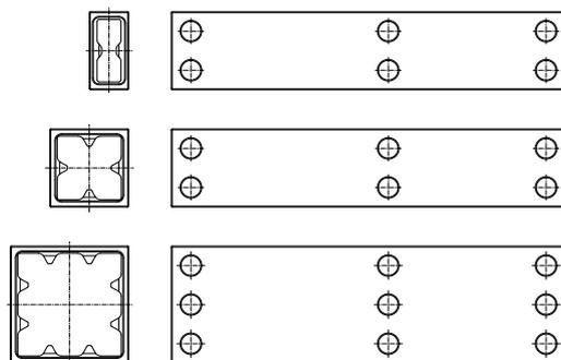
Quader Light CX: für Säulenbauweise mit jeweils einer Bohrungsreihe an den Enden und einer Mittelreihe zum Anbau von Streben.
