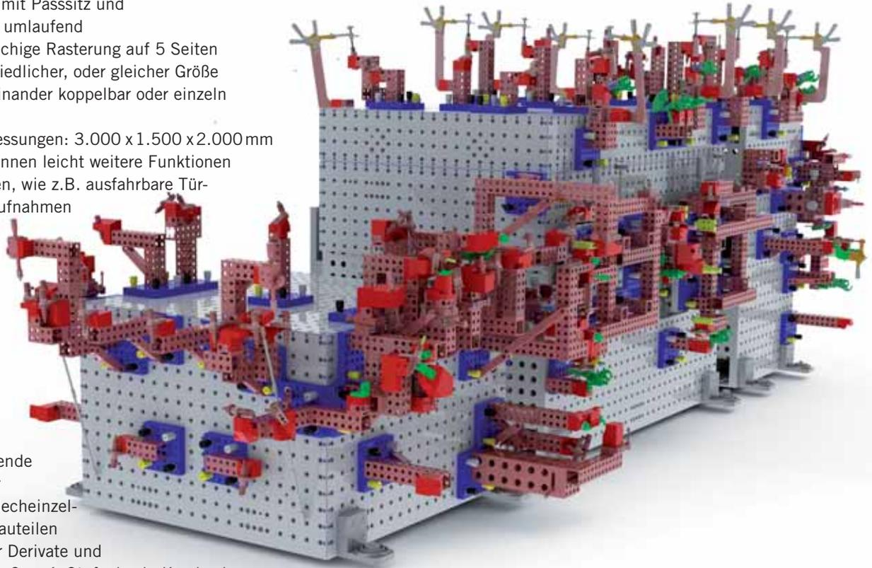
Durch entsprechende Konfiguration zur Aufnahme von Blecheinzel- und Zusammenbauteilen unterschiedlicher Derivate und Fahrzeugmodelle: Coupé, Stufenheck, Kurzheck, Limousine, Kombi, Van, SUV.
