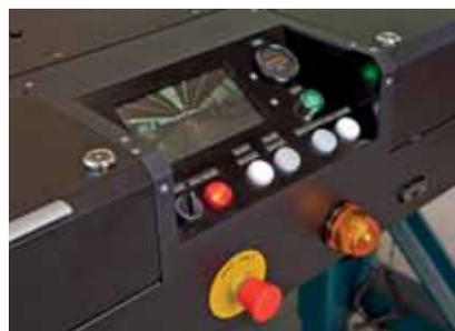
Bedienpult mit Fahrweg-Monitor
