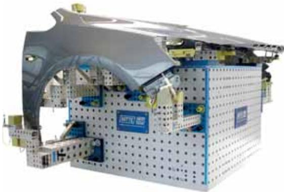
Fixbase Box für Aufnahme Einzelteile Vorderwagen
