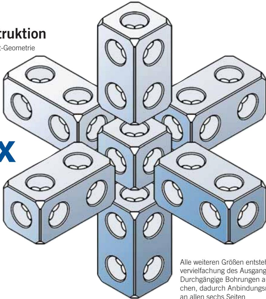
Alle weiteren Größen entstehen durch vervielfachung des Ausgangswürfels. Durchgängige Bohrungen auf allen Flächen, dadurch Anbindungsmöglichkeiten an allen sechs Seiten
