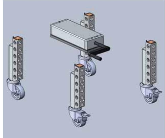
Das Lenkrollenset ist für Vorrichtungen bis zu einem Gewicht von 350 kg geeignet. Der Hub beträgt max 150 mm. Pro Rolle werden 3 Meter vorkonfektionierte Hydraulikleitung mitgeliefert. Zur Anbindung werden die unten aufgeführten Aufnahmeprofile benötigt.
