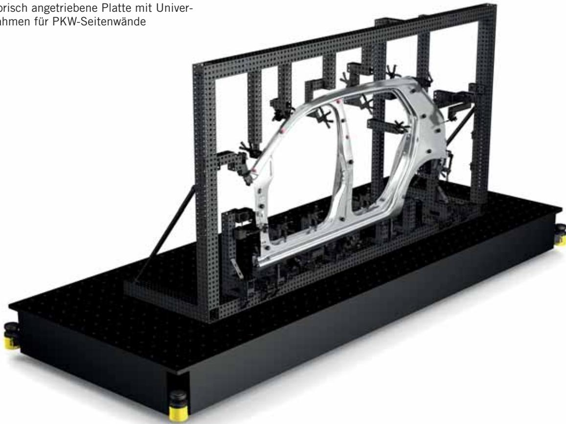
Anlage mit 2 senkrechten Strukturplatten, 3,2m Gesamthöhe, motorisch angetrieben, mit Funkfernsteuerung
