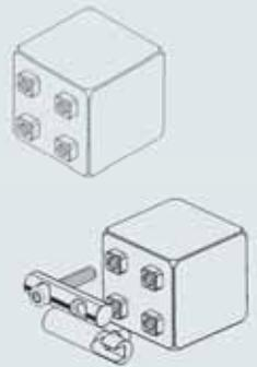
Noppen als platzsparende Anbindungsmöglichkeit für Schlitten, Schnellwechselkupplungen und Passstücke
