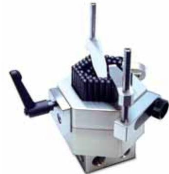
Die leicht beweglichen Nadeln passen sich der Form des Werkstückes an. Durch Arretierung des Adapters kann der „Abdruck“ des Werkstückes fixiert werden und ermöglicht somit reproduzierbare Werkstückfixierung. Das Werkstück wird zusätzlich durch Niederhalterfedern von oben gehalten.
