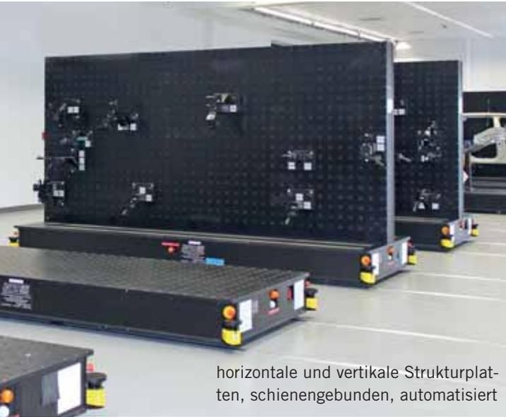
horizontale und vertikale Strukturplatten, schienengebunden, automatisiert
