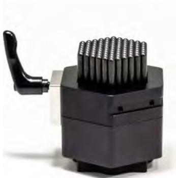
Die leicht beweglichen Nadeln passen sich der Form des Werkstücks an. Durch Arretieren des Adapters kann der „Abdruck“ des Werkstücks fixiert werden und ermöglicht somit reproduzierbare Werkstückfixierungen. Das Werkstück wird zusätzlich durch Niederhalterfedern von oben gehalten.
