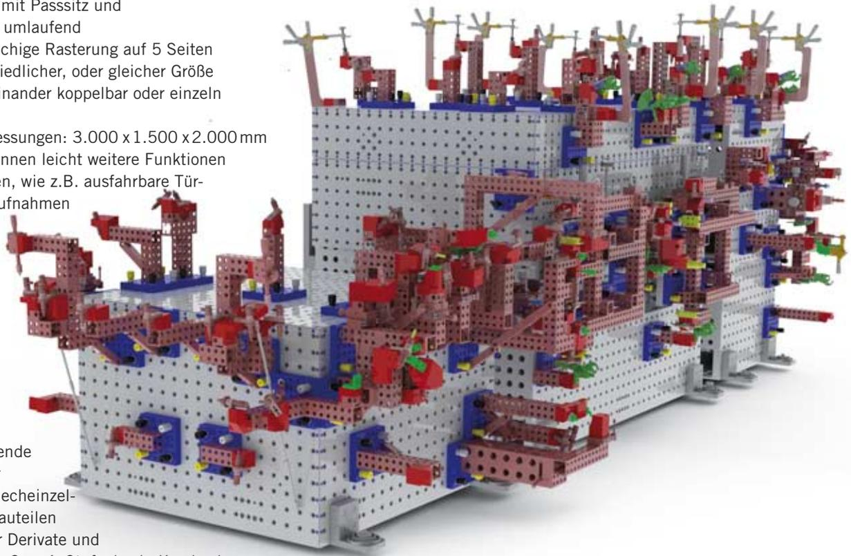
Durch entsprechende Konfiguration zur Aufnahme von Blecheinzel- und Zusammenbauteilen unterschiedlicher Derivate und Fahrzeugmodelle: Coupé, Stufenheck, Kurzheck, Limousine, Kombi, Van, SUV.
