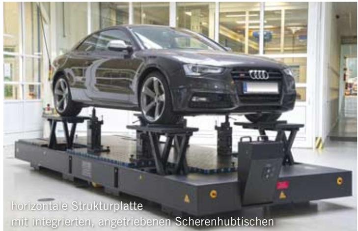
horizontale Strukturplatte mit integrierten, angetriebenen Scherenhubtischen
