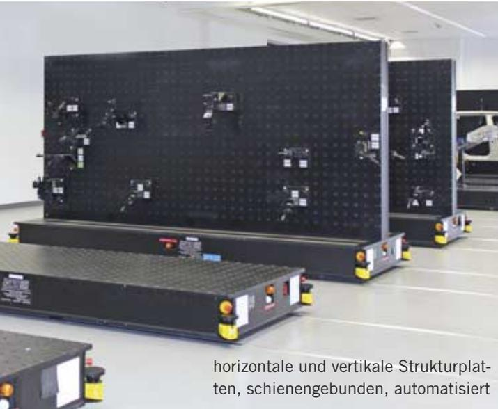
horizontale und vertikale Strukturplatten, schienengebunden, automatisiert
