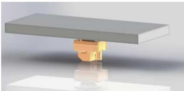
Horizontale Strukturplatte auf motorischem Rundtisch (Ansicht ohne Fußgestell). Die Kräfte werden durch die innere Struktur der Platte auf den Drehteller geleitet.
