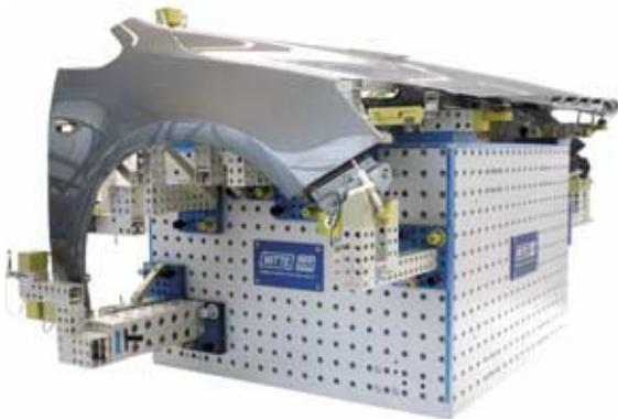
Fixbase Box für Aufnahme Einzelteile Vorderwagen
