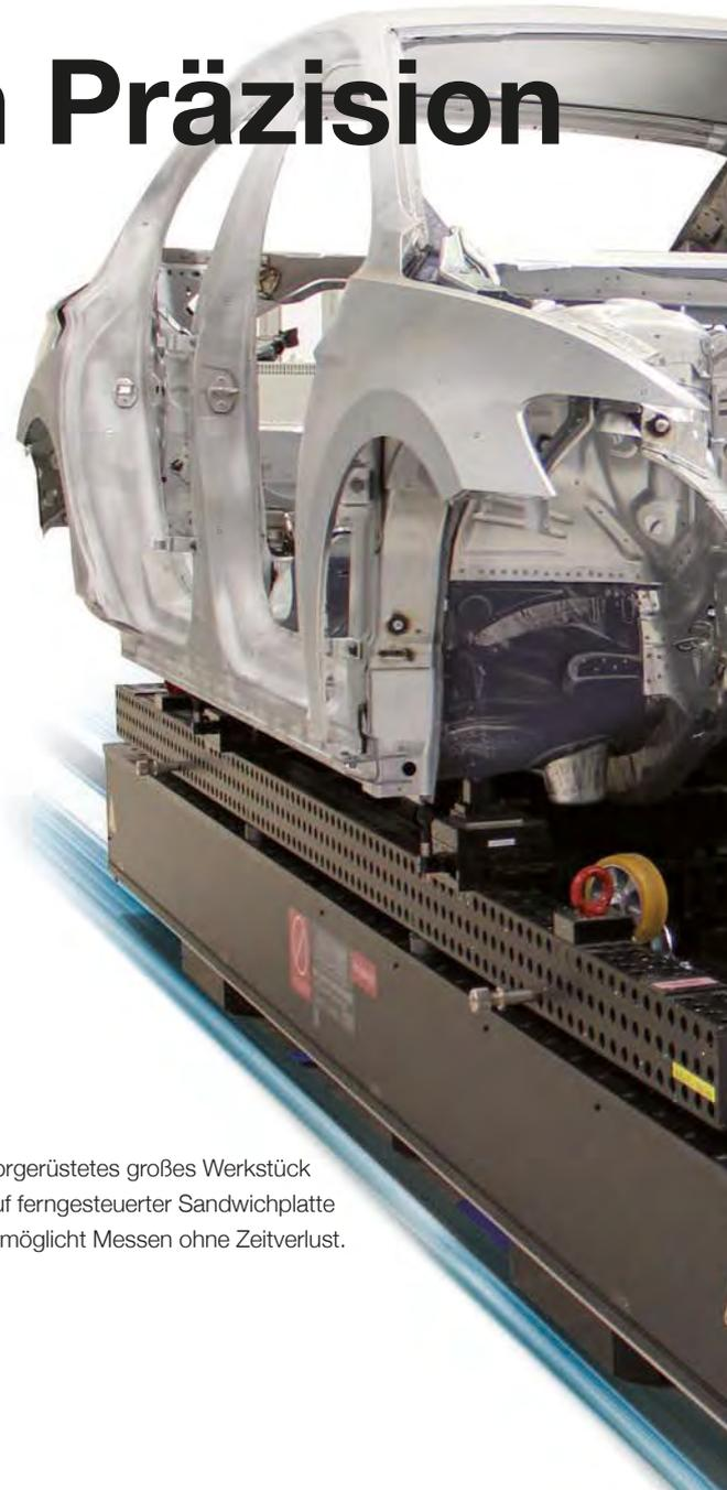
Vorgerüstetes großes Werkstück auf ferngesteuerter Sandwichplatte ermöglicht Messen ohne Zeitverlust.
