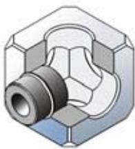
Buchse zum Positionieren
