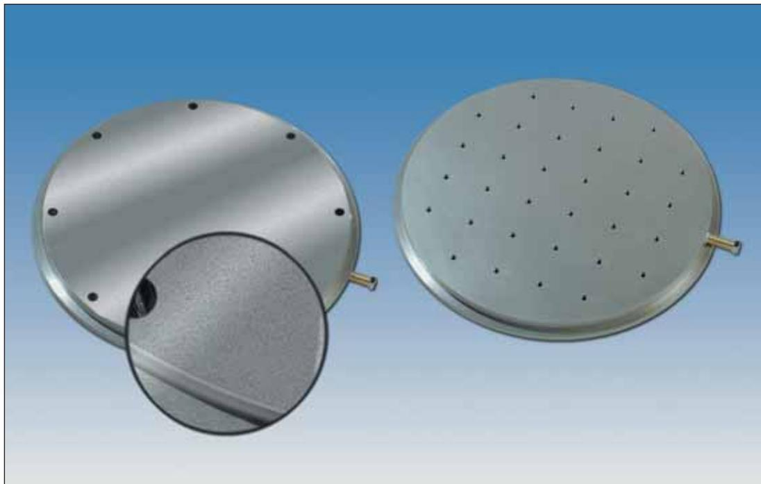
Diese neuartigen Luftlagerplatten bestehen aus einem Grundkörper aus hochfester Alu-Legierung mit eingelegtem porösem Aluminium, welches als Luftlager und zur Luftverteilung dient. Spezielle Gleitstücke auf der Unterseite sorgen für einen präzisen Transport auch bei ungleichmäßiger Belastung.
