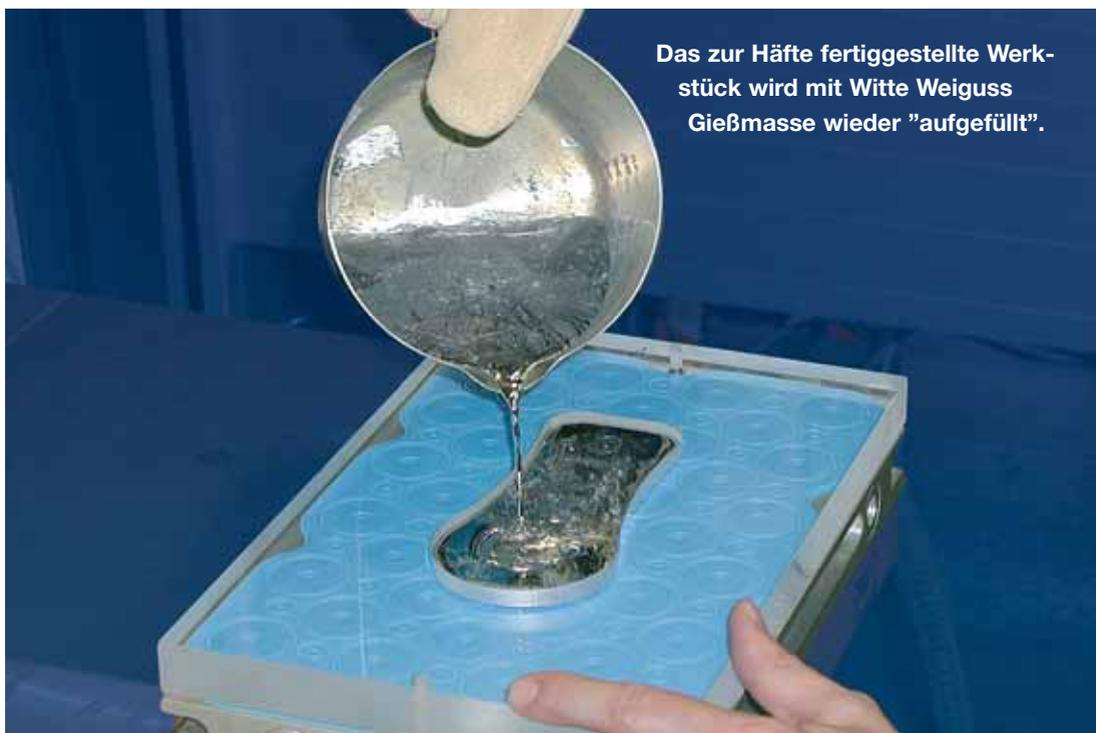
Das zur Hälfte fertiggestellte Werkstück wird mit Witte Weiguss Gießmasse wieder "aufgefüllt".
