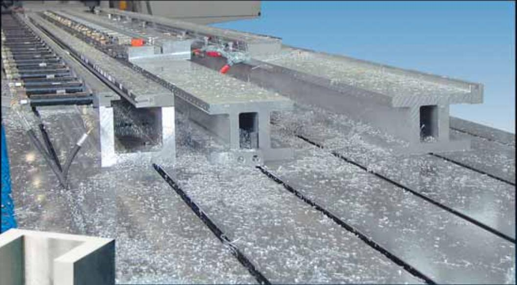
Spannvorrichtung, hydraulisch, 6000mm lang aus U-Profil 70102
