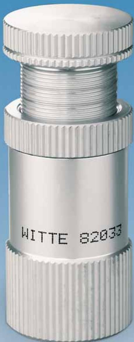
Schraubbock mit beidseitigem Gewinde, dadurch mit sich selbst verlängerbar. Austauschbare Auflageflächen auf Anfrage lieferbar. Außengewinde mit Alu-Kappe gegen Verschmutzung geschützt.
