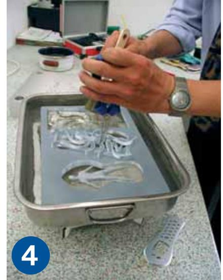
Oben: Abschliessend wird das Werkstück in 80°C warmen Wasser aus der Weiguss-Masse ausgeschmolzen
