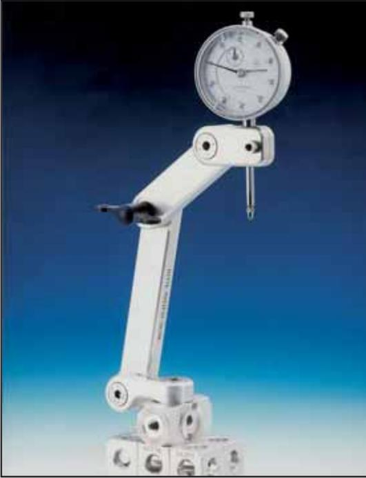
Die Verbindung der einzelnen Elemente wird einfach mit einer Senkschraube, Mutter- und Druckfeder hergestellt. Die Druckfeder gewährleistet die Beweglichkeit der Elemente bei bereits angesetzter Verbindungsschraube. Dadurch wird die Montage erheblich vereinfacht und bereits vormontierte, jedoch noch nicht festverschraubte „Spannarm-Gebilde“ können dadurch als ganzes feinjustiert werden
