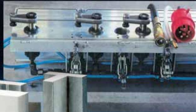
Spannvorrichtung, Vakuum, hydraulisch und mechanisch kombiniert, 6000mm lang aus U-Profil 70102
