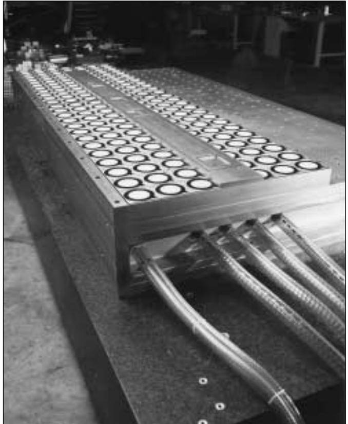
FLIP-POD™ sur un plateau d'adaptation spécial pour fixer des profils en aluminium.
