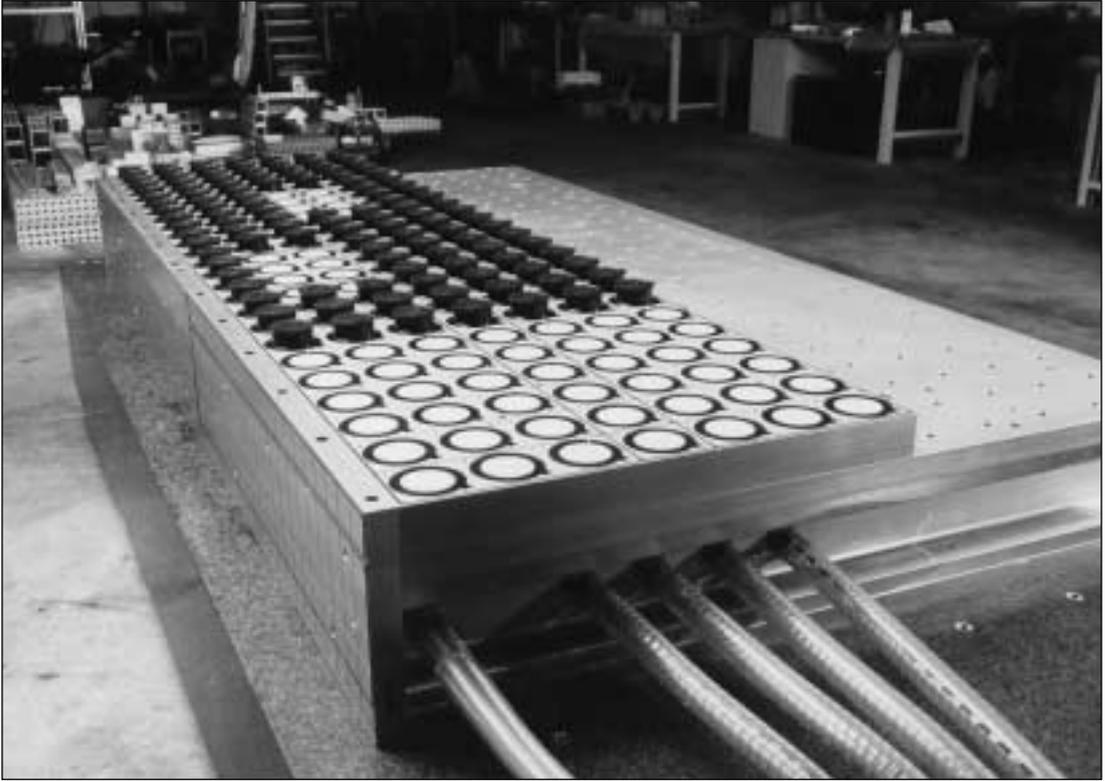
Système FLIP-POD™ en position de fonctionnement ; larges pièces en aluminium avec découpes
