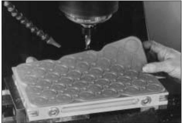
**Les situés en dessous du mat garantissent un positionnement rapide et précis du VAC-MAT™ sur le plateau modulaire à dépression.**
