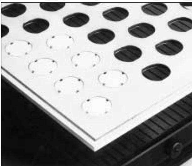
**Plateau par dépression à fentes avec plateau d'adaptation spécial.**
