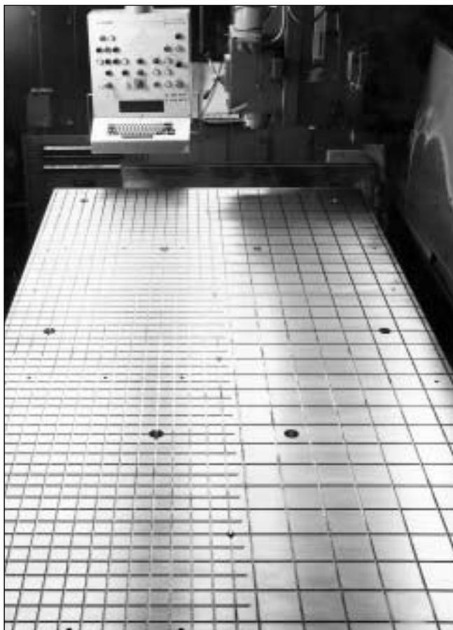
**Cette photo montre une large fixation à grille avec différentes grilles, ce qui permet de fixer des pièces aux dimensions variées simultanément.**
