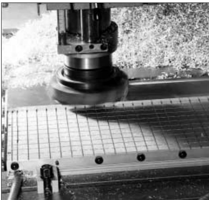
Les forces de fixation élevées permettent un usinage lourd.
