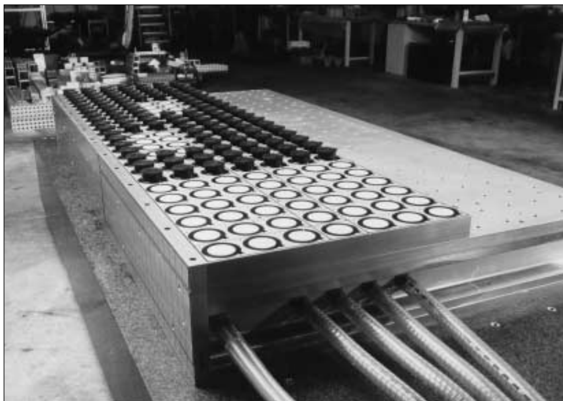
Fig.: Sistema di fissaggio FLIP-POD™ in posizione di lavoro, predisposto per un pezzo in alluminio di grandi dimensioni con fresature.
