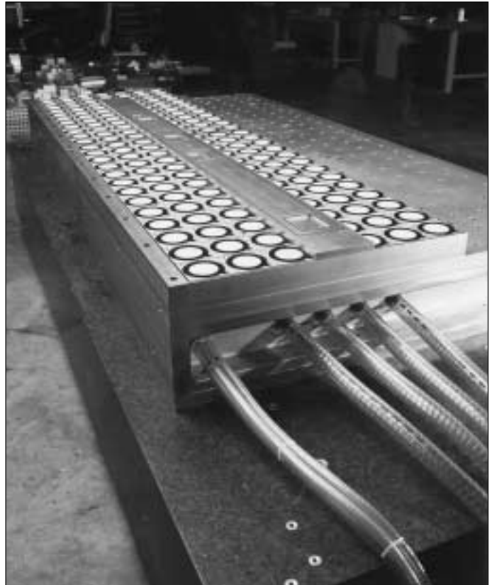
FLIP-POD™ posizionato su una tavola di adattamento, speciale per il fissaggio di profilati in alluminio.
