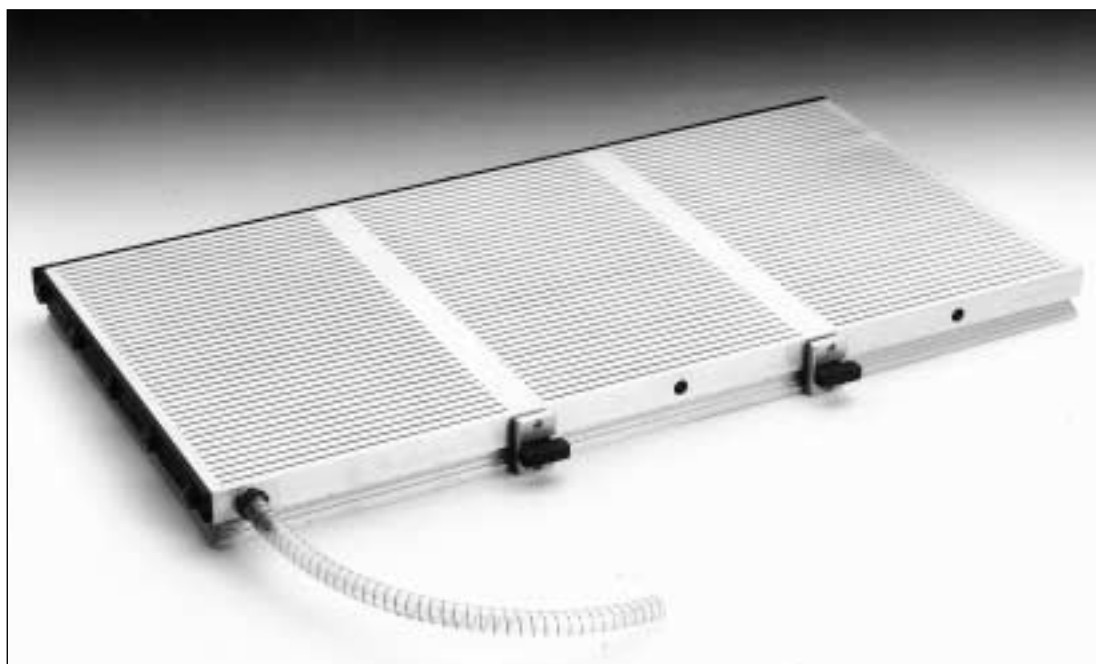
Piano di fissaggio per vuoto con cave, suddiviso in 3 aree funzionanti indipendentemente o in combinazione.
