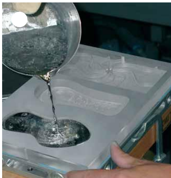
Справа: Заполнение форм расплавленным сплавом Witte Weiguss
