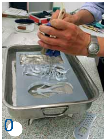
Сверху: Заготовка помещается в воду при температуре 80°C для расплавления и удаления сплава, который может быть использован повторно
