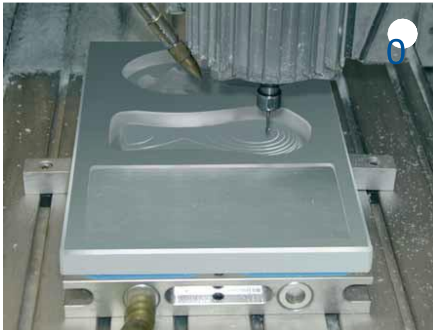
Слева: На первом этапе выполняется стандартное фрезерование поверхности заготовки
