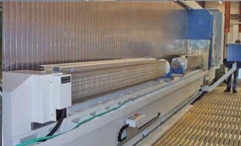
2 вращающиеся системы (каждая 3500 мм) с зонами фиксации вакуумом с четырех сторон для обработки алюминиевых профилей
