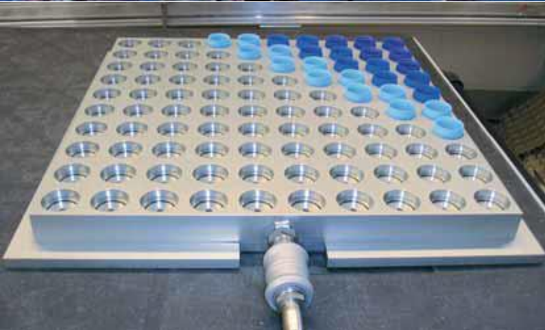
Вакуумная система фиксации горлышек бутылок во время измерения на координатно-измерительной машине
