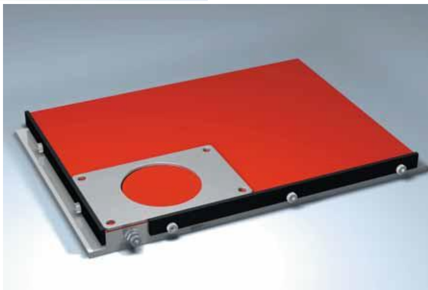
5 Установите заготовку на мате. Отличные свойства трения резинового материала предотвращают высокие нагрузки смещения лучше, чем любая другая вакуумная система
