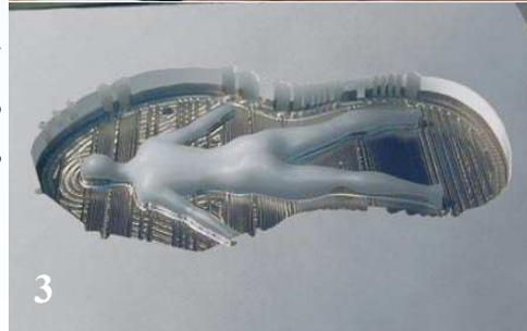
تصویر راست: پس از سفت شدن، قطعه کار برگردانده شده و طرف دیگر آن ماشین کاری می
