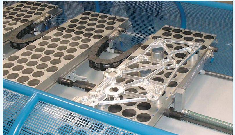
سیستم کلمپینگ flip pod برای دستگاه های deburing در قطعات هواپیما بکار رفته.
