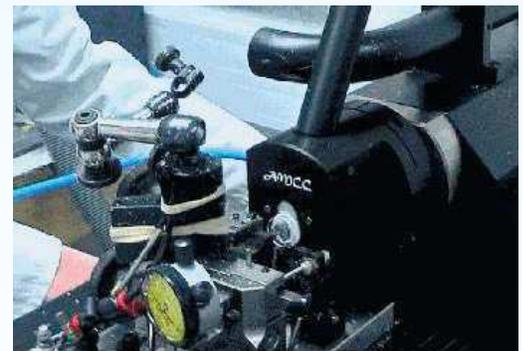
فیکسچر جهت نگهداری قطعه کار بر روی ماشین تراش برای قطره های مختلف مورد استفاده قرار می گیرد.
