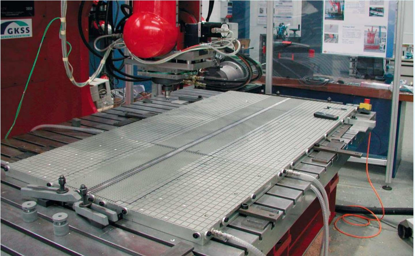
تصویر بالا: صفحه و کیوم شبکه ای دو تکه جهت استفاده در ماشین جوش غلطکی اصطکاکی.
