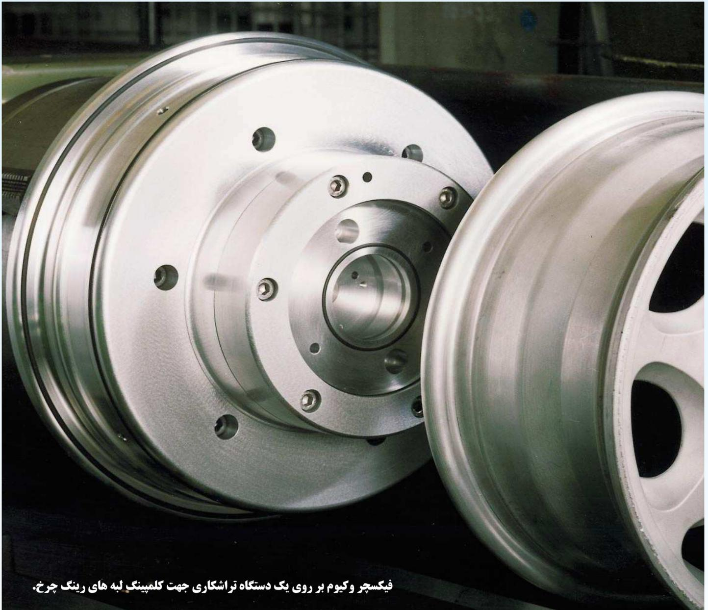
فیکسچر و کیوم بر روی یک دستگاه تراشکاری جهت کلمپینگ لبه های رینگ چرخ.
