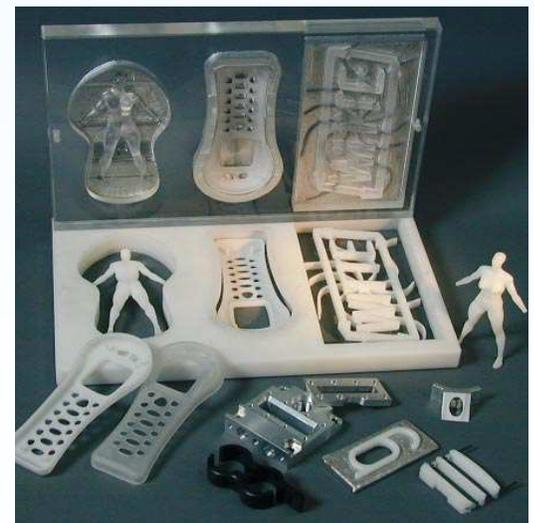
آلیاژ weiguss ویته بخصوص برای قطعه کار های پیچیده با سطوح خمیده و مقعر بسیار مناسب است.
