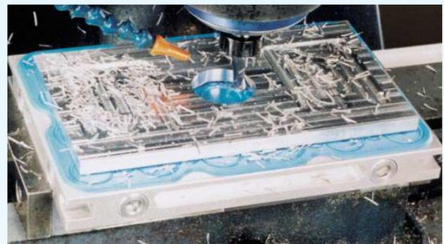
فرزکاری پنج طرفه بر روی یک سیستم کلمپینگ VAC-MAT.
