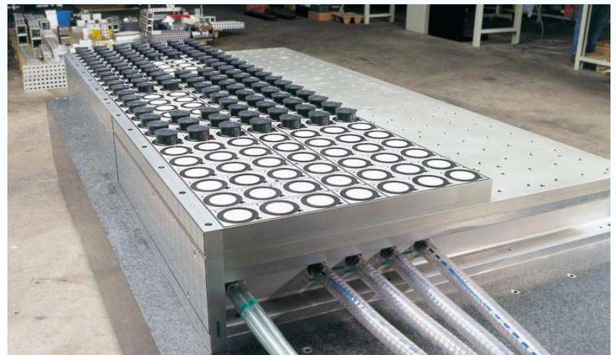
سیستم کلمپینگ flip pod در موقعیت کاری برای قطعات آلومینیومی برش خورده بزرگ.
