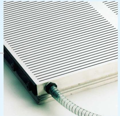
کلیه صفحه های وکیوم شیاری دارای شیارهای یکپارچه در سطح خود بر اساس نیاز مشتریان می باشند. به منظور کلمپ یا مهار قطعانی که کل سطح را نمی پوشانند، لایه های تعدیل کننده لاستیکی یا فویل جهت پوشش قسمت غیر ضروری تحت خلاء استفاده می شود.
