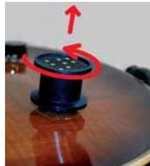
**4** Nach der Messung das Ganze rückwärts: Adapter hochziehen und mit einer Linksdrehung um 30° arretieren
